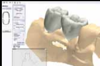
Bild 5: Design und virtuelle Erstellung der Kronen am PC mit Camlog Guide. Dabei wird berücksichtigt, dass die provisorischen Kronen niedriger als die natürlichen Zähne sind, um die Implantate nicht mit der vollen Kaukraft zu belasten. Die Daten werden an die CAD/CAM-Anlage versendet und die Kronen nach Vorgabe genau gefräst.
